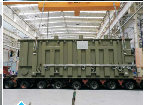
爱沙尼亚 ENERGEL项目 SFSZ-200MVA 347kV
