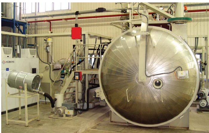
▲ 从德国旭百世(HUBERS)引进的真空浇注设备，采用薄膜脱泡和静态混料等专利技术，保证了变压器低局放。
